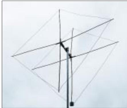
Bild 8: Fertige 2-Element-Quad im Betriebszustand
