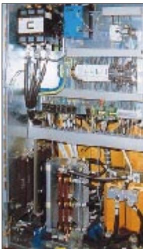
Bild 2: Netzteil des 100-kW-Transistorsenders; unten links die Gleichrichtereinheit, dahinter der Netztransformator, statt hoher Spannungen gibt es hier erhebliche Ströme.
