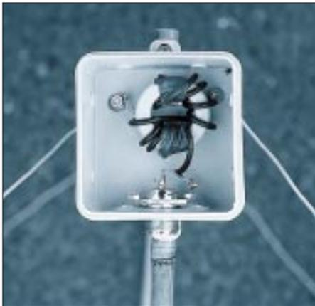
Bild 6: Der Anschlußkasten mit dem Balun
